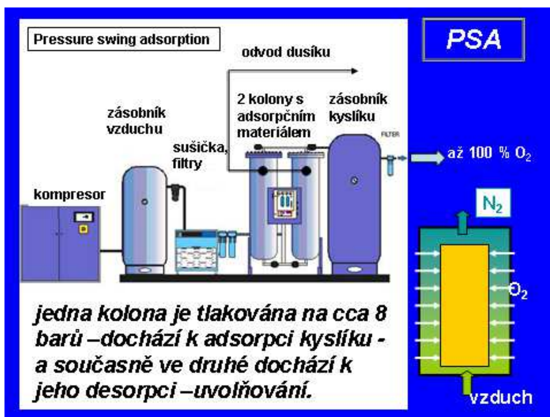
Obr. 6. Princip střídavé tlakové adsorpce
